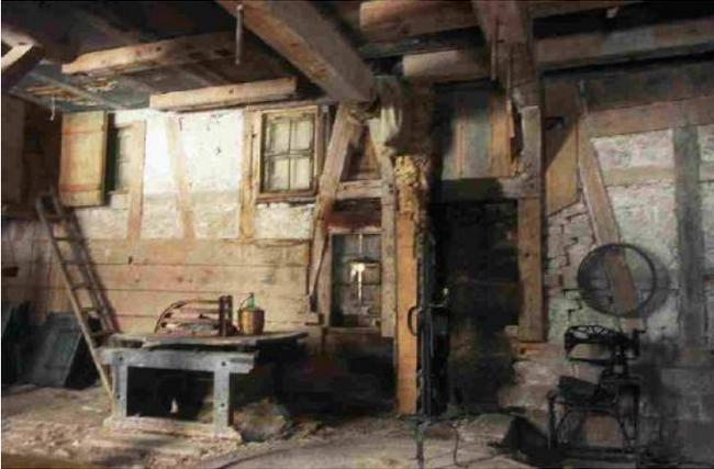
Hier in diesem oben abgebildeten Raum wurde mittels eines Mahlwerkes die in der Gesteinspoche grob zerkleinerten Steine staubfein zermahlen, bevor der Gesteinsstaub in der Schmelze landete.
